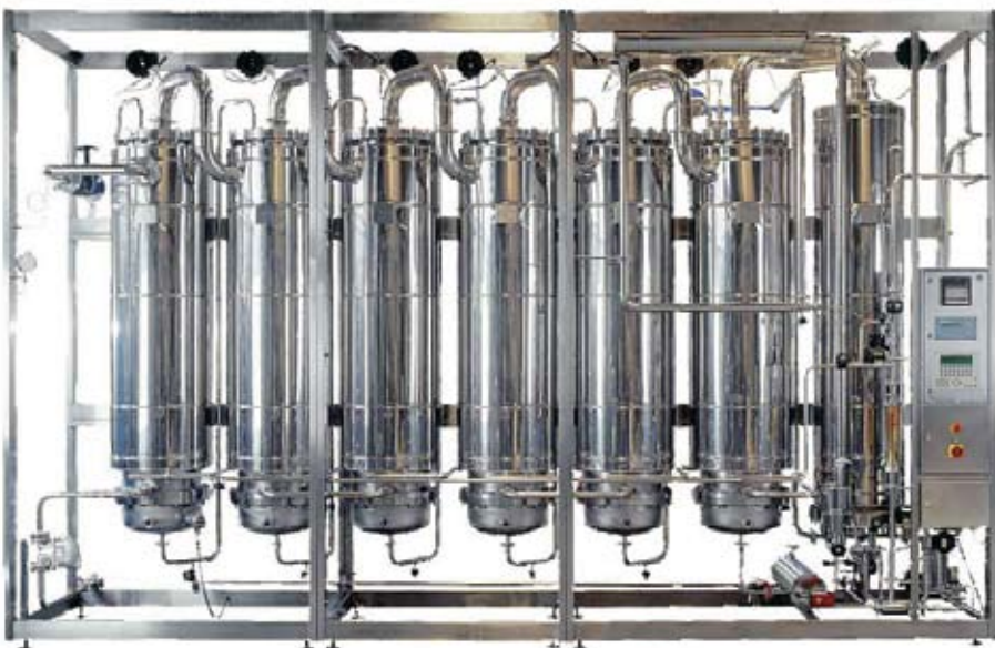
■ Многоколоночные дистилляционные установки для получения воды для инъекций и генераторы чистого пара
